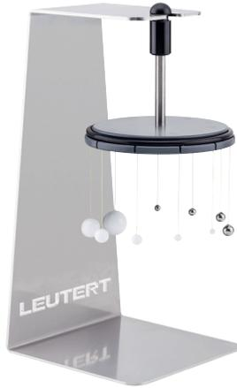
Auf der Scheibe sind die einzelnen Kugeln durch laufende Nummern 1 bis 10 gekennzeichnet. Bitte notieren Sie die kleinste Nummer der eingetauchten Kugeln (gespannter Faden).
